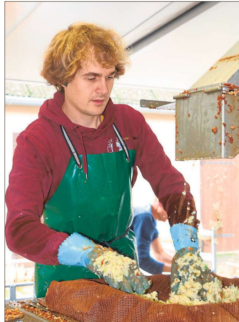
Die klein gehäckselten Äpfel fasst Christian Jäger in ein Nylontuch ein. Von dort gelangt die Masse in die eigentliche Presse.
